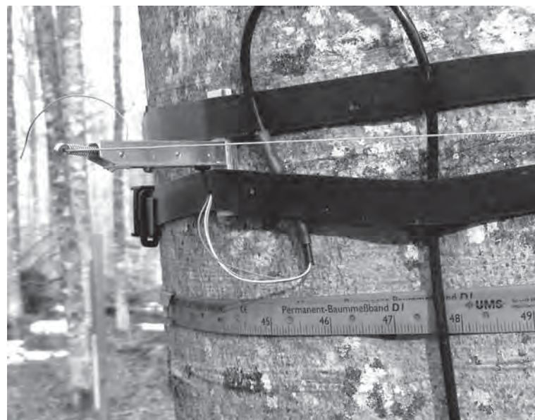
Methodenvergleich zur Messung des Baumdurchmessers
